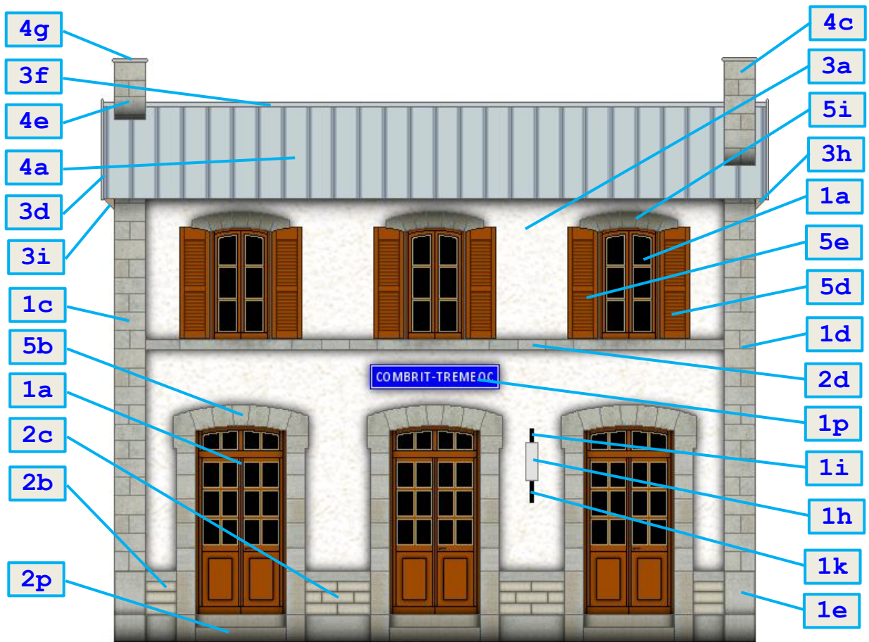
- Façade côté voie -
