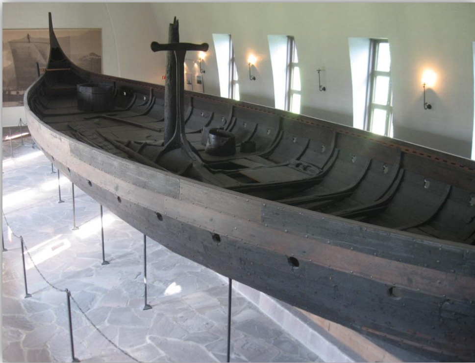
Les différences de couleur des bois du bateau restauré sont volontaires : les parties trop abîmées ou déformées et fragilisées, ou manquantes, qui ont donc du être remplacées, ont été teintées plus claires afin d'être aisément distinguables des bois originaux plus foncés.
