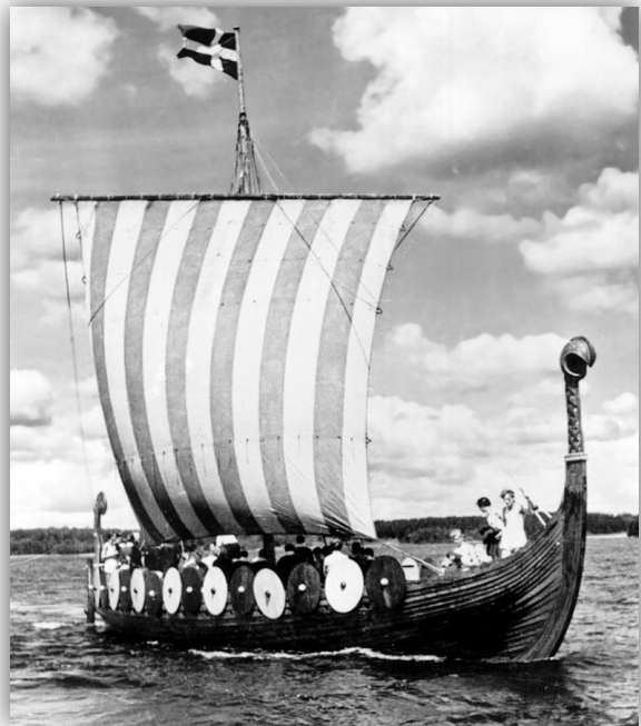
Ormen Friske , réplique du bateau de Gokstad lancée en 1949. Elle a fait naufrage en 1950 : sa quille s'est brisée par gros temps, quinze morts... Sa quille en lamellé-collé était certes mal faite mais cela démontre néanmoins combien le gabarit de la lame de couteau qu'est la quille du bateau de Gokstad est à la limite, car elle travaille beaucoup vu la grande souplesse de la coque.
